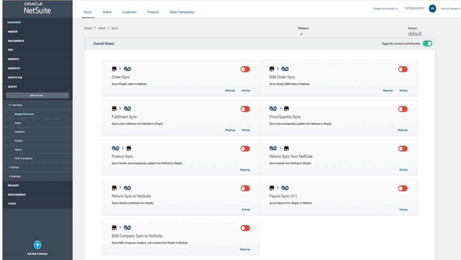
Figure : L'interface du connecteur Shopify de NetSuite permet d'activer la synchronisation automatique de divers flux de données (commandes, expéditions, produits, clients, etc.) entre la boutique en ligne et l'ERP NetSuite.
